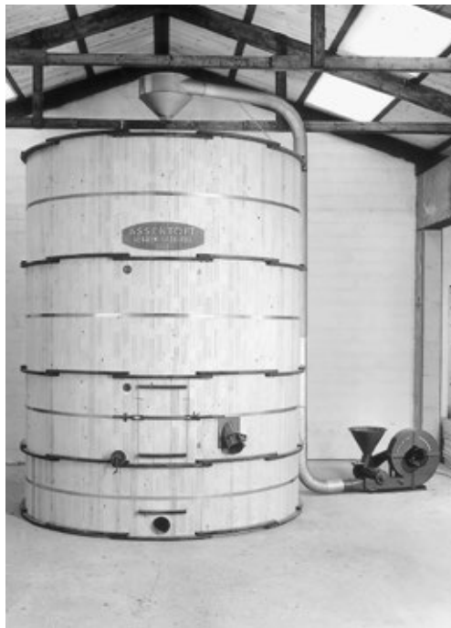
Opstilling med gennemblæsningssilo, kornblæser, fylderør og cyklon.
