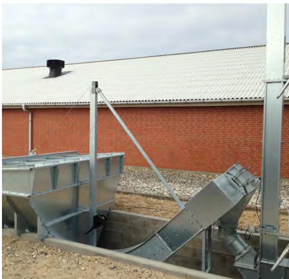
Assentoft påslag/tipkasse i galvaniserede plader.
