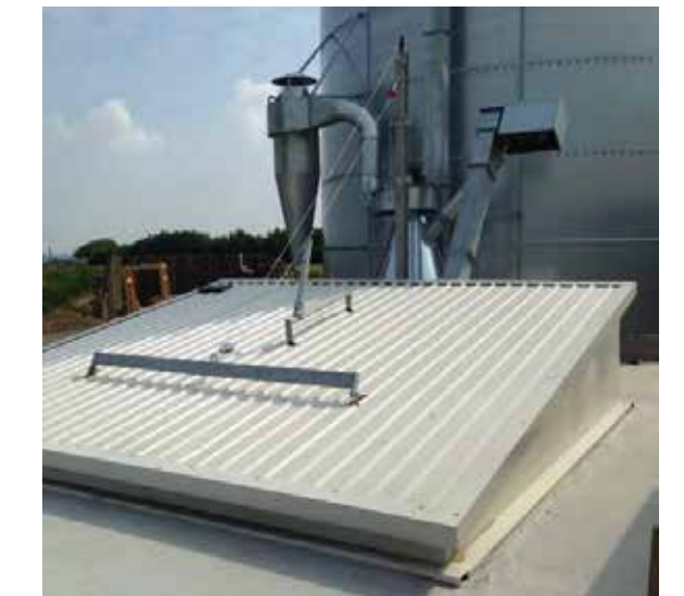
Assentoft helsvetsad, vertikalt spannmålsmagasin i stål, utfört i tjocka plattor. Levereras i förbehandlat utförande. Inkluderar ett elstyrt lock.
